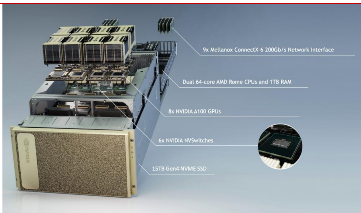
图 11: 英伟达 DGX A100 服务器拆分图
